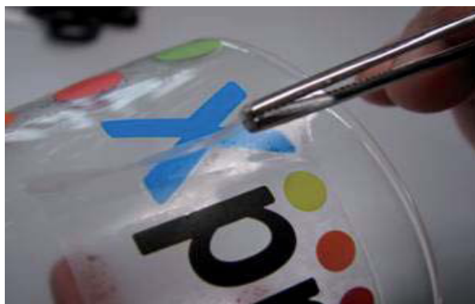
Obrázok: Odstránenie snímateľného náteru 80 2039
